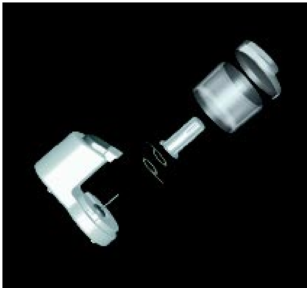
A felülről lefelé tervezés kezdődhet termékstruktúrával -- mielőtt a darabok létrejőnének. A rugalmas hierarchiakezelő eszközök segítségével könnyen létrehozható és módosítható a termékstruktúra.
